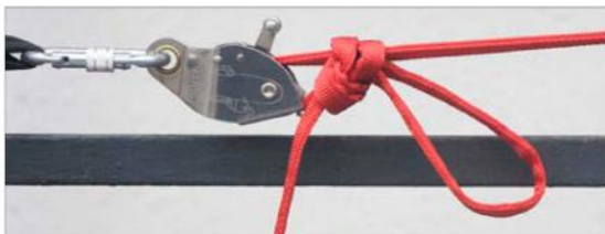
Nó de pescador para bloquear a ancoragem
