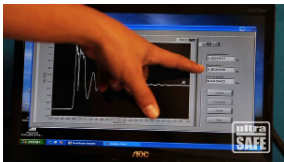
Fuerza máxima atingida = 4,86 kN / Factor de Queda 1
